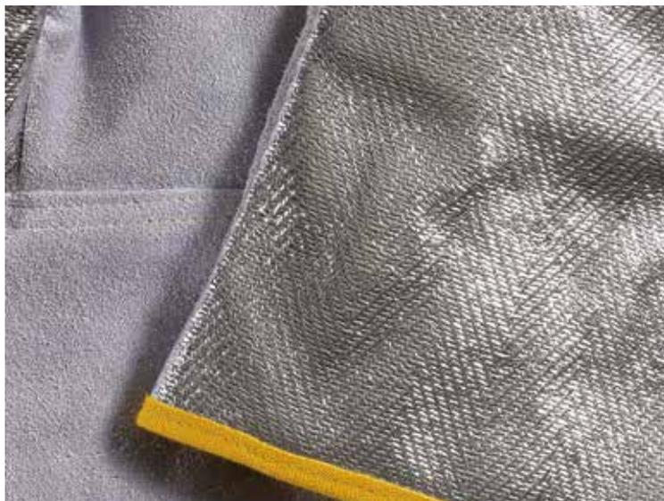
Il dorso alluminizzato è ideale in caso di saldatura prolungata: riflette il calore e protegge dagli schizzi di saldatura.
