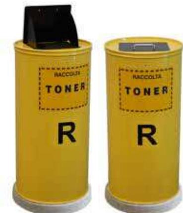
Forma cilindrica verticale, fondo piano. Acciaio zincato anticorrosione per esposizione permanente agli agenti atmosferici, con verniciatura esterna con polveri essiccate al forno. Colore standard giallo, lavabile e disinfettabile. Coperchio apribile con serratura a chiave. Bocchetta superiore di immissione auto scaricante antiprelievo colore nero, con maniglia cromata. Scritta adesiva di identificazione del rifiuto, applicata sul contenitore.
