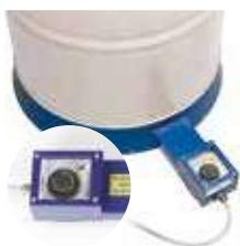
Realizzato con 2 lastre di metallo spessore 2 mm, estremamente rigide. Il riscaldamento è prodotto per mezzo di una resistenza piatta in silicone con potenza 900 W con una perfetta distribuzione del calore su tutta la superficie. Isolata con 50mm di lana di roccia ad alta densità garantisce un ottimo isolamento alla superficie d'appoggio del riscaldatore. Classe di isolamento I - Termostato 0-150°C - Fornito con 2 mt di cavo per alimentazione corazzato - di semplice installazione.
