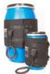
Realizzato con tessuto di ottima qualità ed estremamente resistente, in doppio isolamento il riscaldatore incorpora un termostato a capillare 0-90°C che permette un ottimo controllo della temperatura. È fornito con un semplice ed efficace sistema di fissaggio con cinghie di trazione per una ottimale installazione. Dotato di isolamento in teflon/poliestere. Fornito con 3 mt di cavo per alimentazione.
