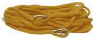
FUNE DI SERVIZIO Composto da treccia in fibra di kevlar senza anima interna.  $\varnothing$  10 mm - lunghezza 20 mt. Forza di rottura: minimo garantito 3400 kg. Carico di rottura sulle asole impalmate e mano: 2700 kg. Alta resistenza al calore.
